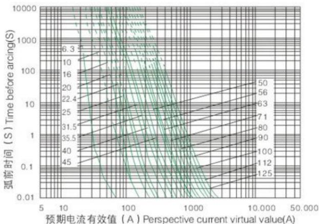
A/B型12KV熔断件时间-电流特性 Time-current characteristics of fuse link type A/B
