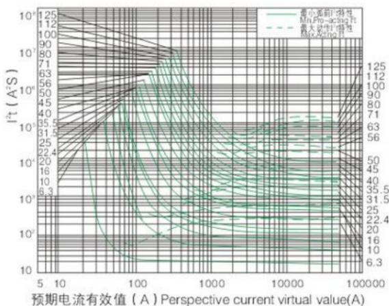
A/B型12KV熔断件 $I^2.t$ 特性 $I^2.t$  characteristics of fuse link type A/B
