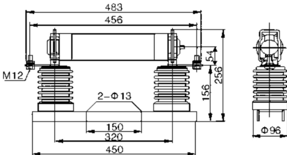
12KV熔断器底座外形尺寸
